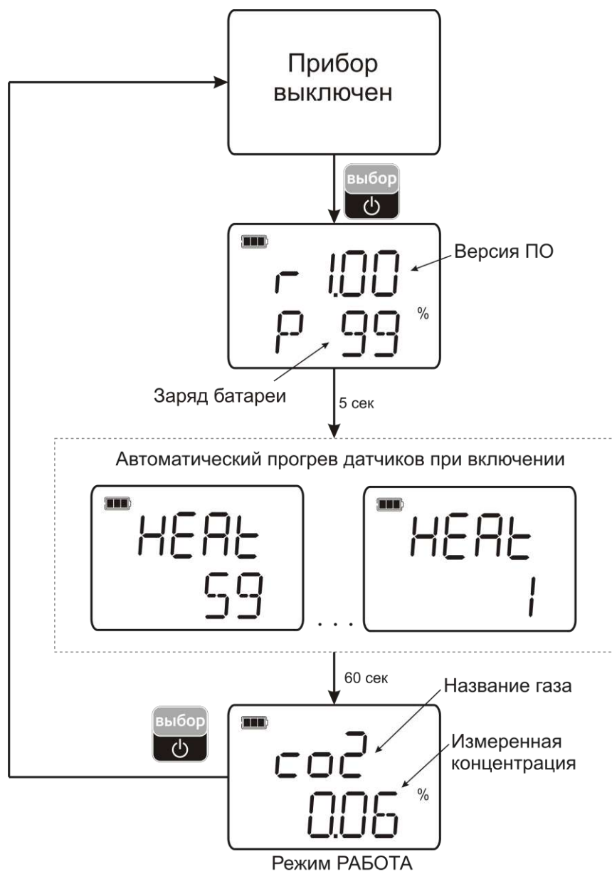
Рисунок 5.1 Схема режима РАБОТА
